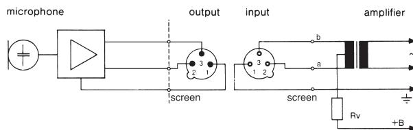
Círculo com transformador de entrada **sem** derivação central (isolado da terra):
